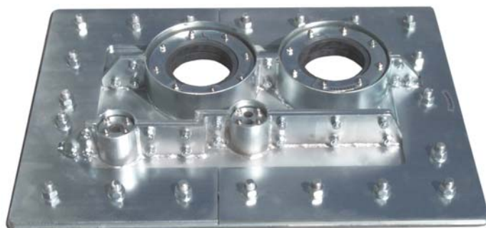
Фланцевый элемент, «МУЛЬТИ», открывающийся вариант, для нескольких уже проведённых труб с разными диаметрами, с уплотнительными вставками.
